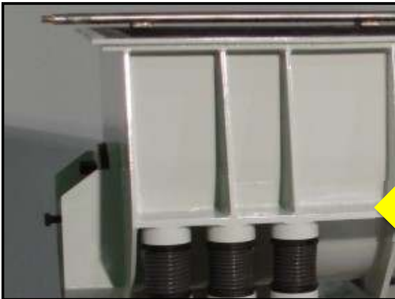
RWP-L-770/P-CF [US] - dettaglio della doccia in acciaio inox, della portella di scarico laterale, delle protezioni di sicurezza delle molle; RWP-L-770/P-CF [US] - detail of the stainless steel sprinkler, of the side unloading door and of the springs safety protections;
