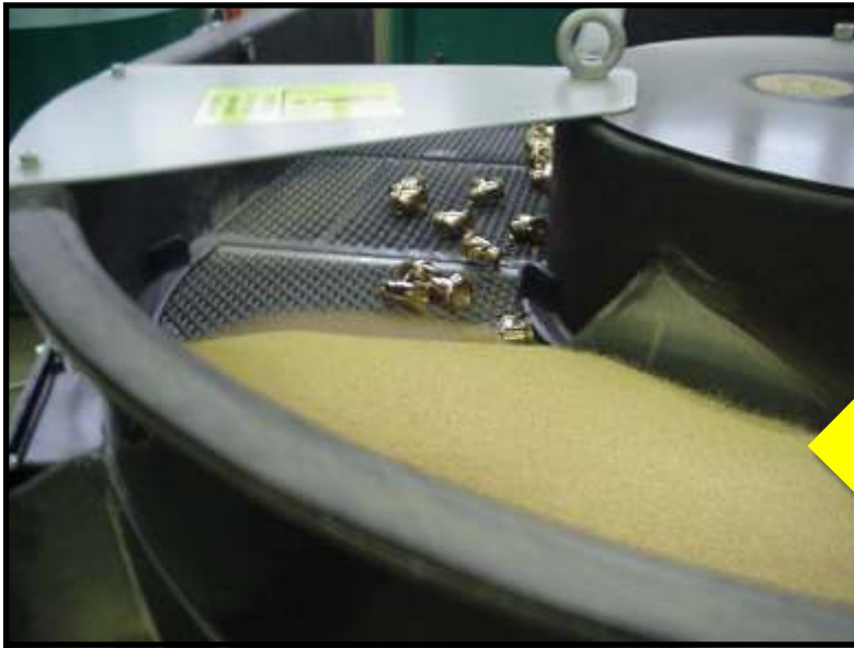
RWO-AS-3/G - fase di scarico di articoli in ottone asciugati RWO-AS-3/G - unloading phase of dried brass articles
