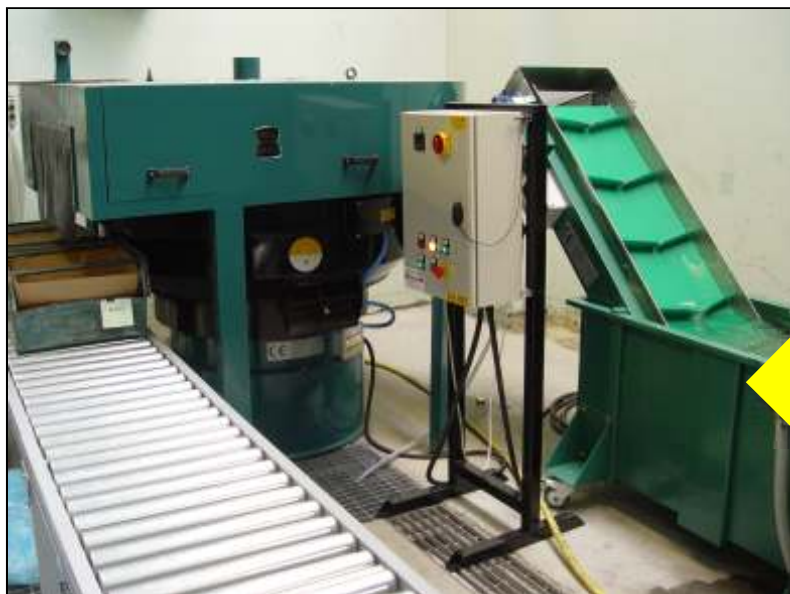
RWO-AS-3/G + AFOCOP-AS-3/Dust - alimentato in continuo da una vasca di risciacquo UNIVAR-PVC, scarica in contenitori su rulliera. RWO-AS-3 + AFOCOP-AS-3/Dust - feeded in continuous through a UNIVAR-PVC rinsing tank, it unloads the pieces in container on roller.
