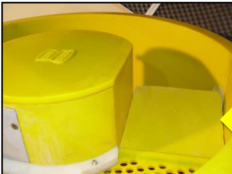
Il flap di scarico è realizzato in PU, con geometria rettangolare e movimento preciso nella sede stampata. The unloading flap is made in PU, with rectangular shape and precise movement in its moulded housing.
