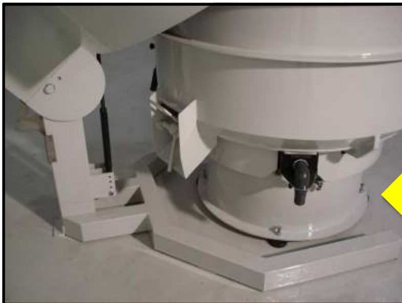
La valvola di scarico reflui, di design Rollwasch® e corpo in PU, offre ottima tenuta e semplicità di impiego. (versione PRO). The wastewater unloading valve, of Rollwasch® design and with PU body, offers a very good tight and it is easy to be used. (PRO version)
