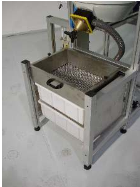
Dettaglio della valvola di scarico standard e del vaglio di separazione con due vasche di raccolta; - Detail of the standard unloading valve and of the separating sieve with two reception boxes;
