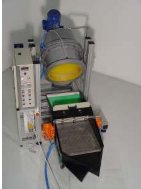
RDF-70-BASIC-WET-SV/ES - in fase di scarico sulla tramoggia del vibrovaglio; - during the unloading phase on the separator hopper;
