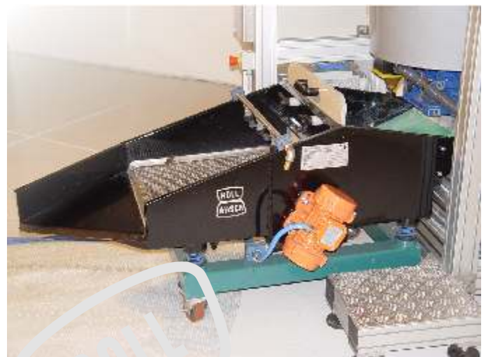
UNID-4-CT - Vibrovaglio con tramoggia, completo di ugelli di risciacquo; vibratory separator with hopper, complete with rinsing sprinklers.
