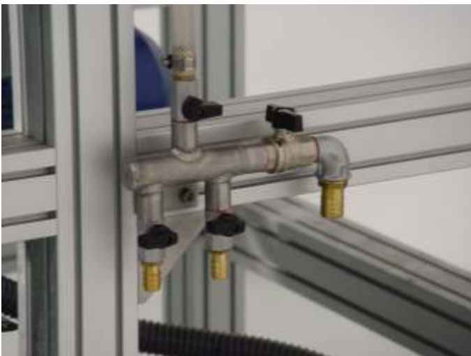
RDF-70-BASIC-WET-SV/ES - Connessioni idrauliche lato macchina personalizzate per il cliente; - customised water connections on a machine side,
