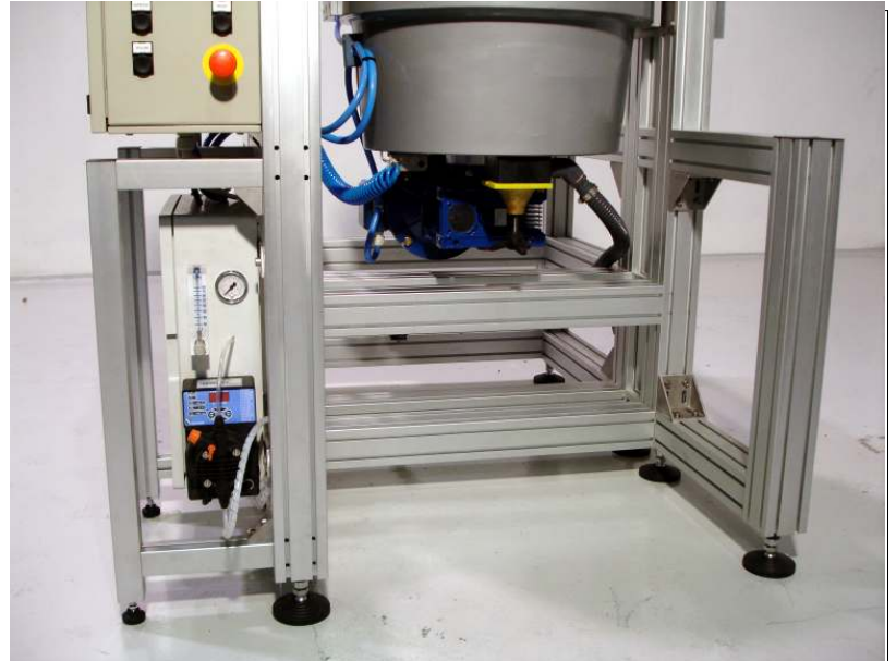
RDF-70-BASIC-WET-SV: dettaglio della stazione di dosaggio e miscelazione automatica acqua/composto MK; detail of the station for automatic dosing and mixing of water and compound MK;
