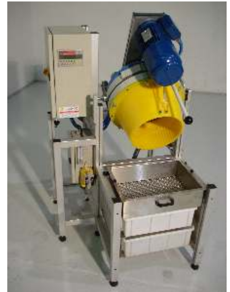
Vasca ribaltata durante la fase di scarico; - tilted tank during the unloading phase.
